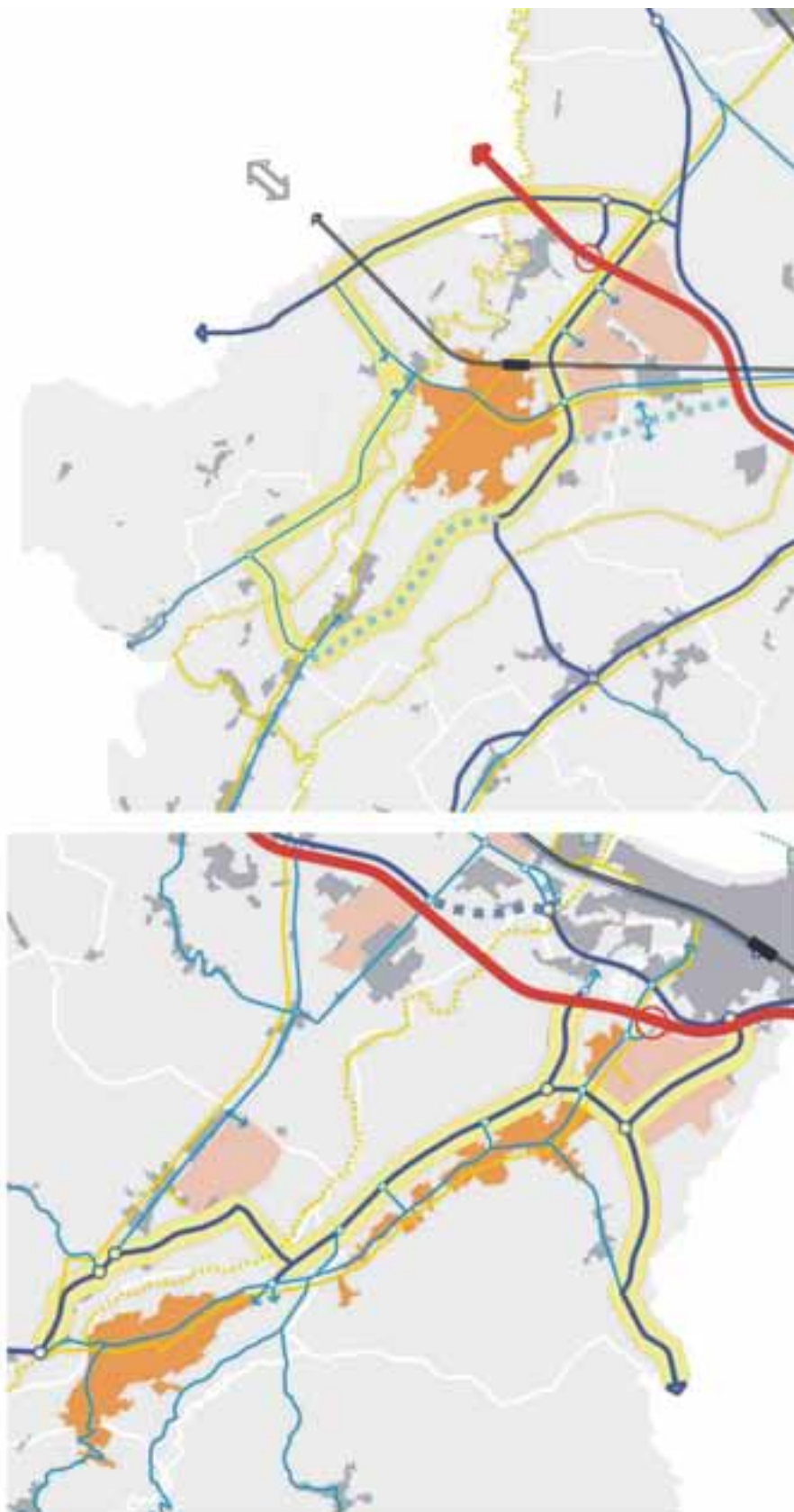
Schemi SR 14 e 15 - Particolari della viabilità di vallata per la Val Marecchia e la Val Conca con evidenziati i tracciati viabilistici per il by - pass dei centri intermedi (Santarcangelo, Morciano e San Giovanni)
